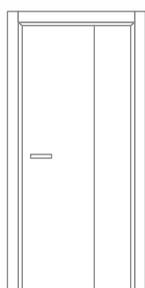
Porta pieghevole realizzata con antine asimmetriche con apertura a spinta. Apertura con maniglia e serratura tradizionali.
