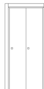
Porta pieghevole realizzata con antine simmetriche con serratura centrale e maniglie ad incasso.
