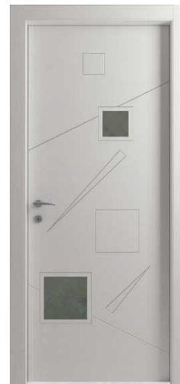
Porta cieca piana tamburata, disponibile nelle versioni a battente, scorrevole interno o esterno muro, pieghevole simmetrica (DUO) o pieghevole asimmetrica 1/3-2/3 (PIEGO). Il telaio perimetrale esterno è in legno massello di abete di circa mm 37x32, essiccato, epurato da nodi e canastro, giuntato a pettine. Il riempitivo in struttura alveolare trattata antitarlo e antimuffa ed il rivestimento in pannelli di fibra di legno a media densità dello spessore di 6 mm.
