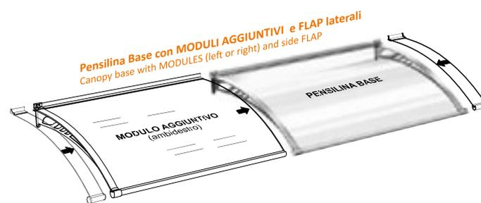
Mensele portanti in acciaio trattate contro la corrosione, verniciate con polveri epossidiche colore antracite di serie (altri colori a richiesta). Grondaia e sovrastruttura in alluminio estruso 6060/T5, colore argento satinato (unica finitura disponibile). Copertura in policarbonato semitrasparente con protezione UV, in finitura Frosted (unica finitura disponibile). Viteria per l'installazione fornita di serie.
