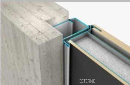
4 Soluzione standard senza profili di copertura telaio lato esterno
